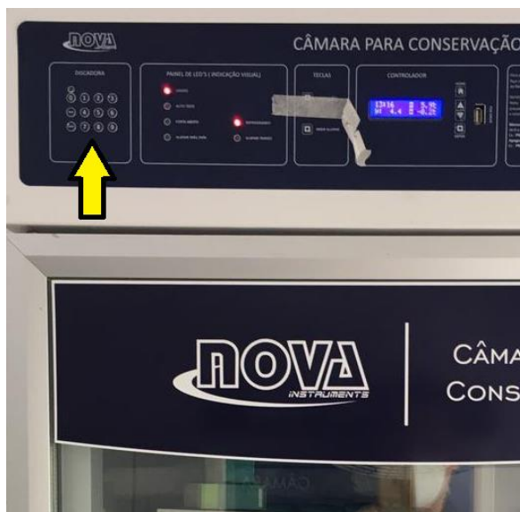
Figura 66. Painel de configuração de números da discadora de câmara refrigerada (UBS Jerônimo Ribeiro - Vargem Alta)
