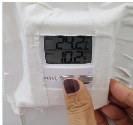
Figura 51. Temperatura máxima do refrigerador doméstico registrando +10,2°C (UBS Vitório Bossato - município de Piúma )
