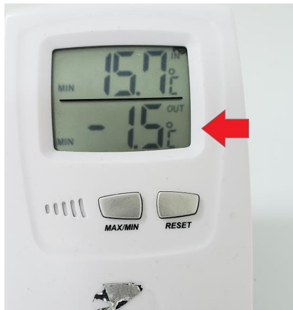
Figura 49. Termômetro registrando -1,5°C na geladeira da sala de vacinação (ESF Maria Helena – Piúma)
